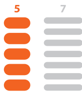
NUR 5 STATT 7 SCHWEISSLAGEN ERFORDERLICH
